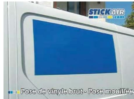
Quand il n'y a plus de liquide entre le support et l'autocollant, la colle adhère à nouveau et permet la fixation au support.
